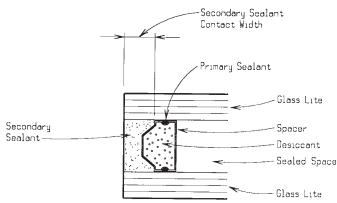
FIG. 1 Sealed IG Edge Seal: Basic Components
