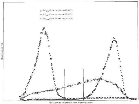
FIG. 3 Spectrum of <sup>210</sup>Pb <sup>210</sup>Bi <sup>210</sup>Po
